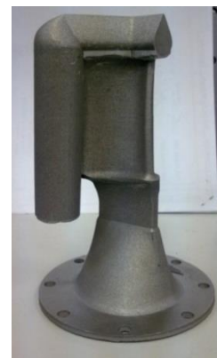
б) прототип лопатки, изготовленный по SLM-технологии
