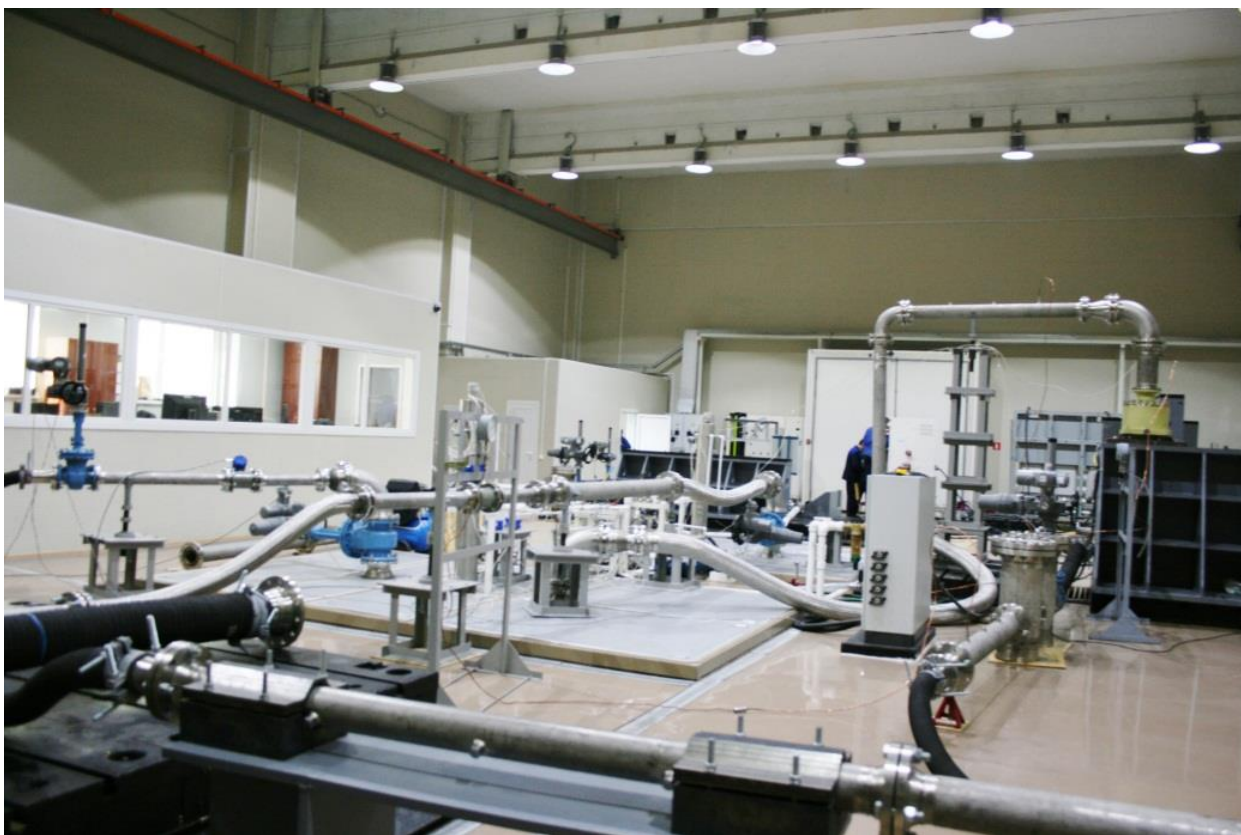
Рисунок 2 – Испытательный стенд для испытания насосных агрегатов производительностью до 7600 м 3 /ч
