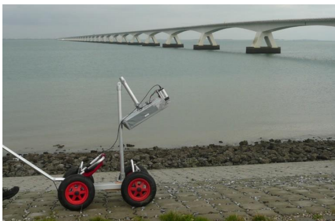
Рисунок 5 – Исследования дамб в Нидерландах с помощью портативных радиометров «Ранет»
