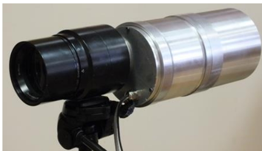
Рисунок 2 – Гиперспектрометр для малого космического аппарата
