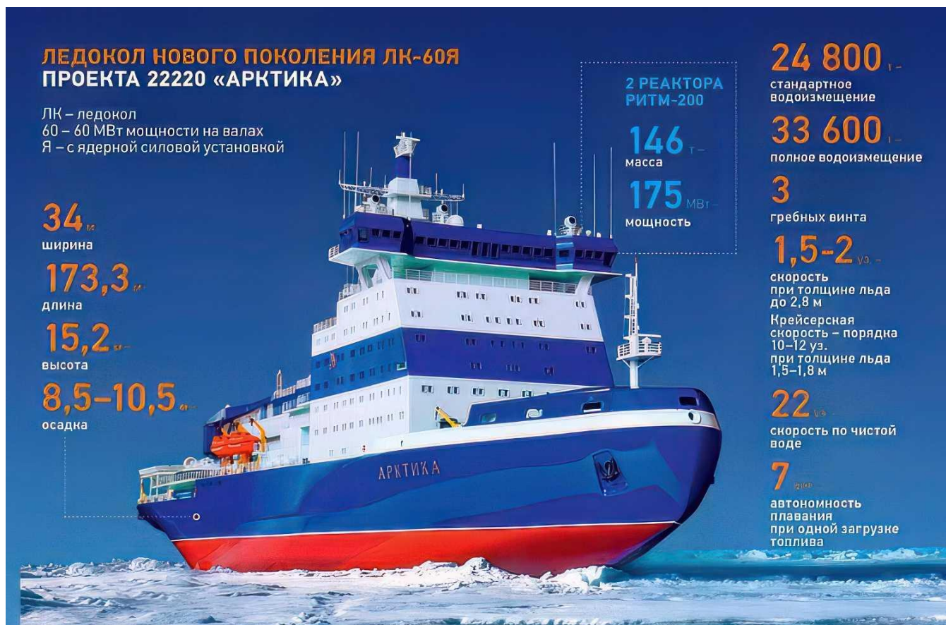
Рисунок 1. Основные технические параметры ледокола нового поколения проекта 22220 «Арктика»
