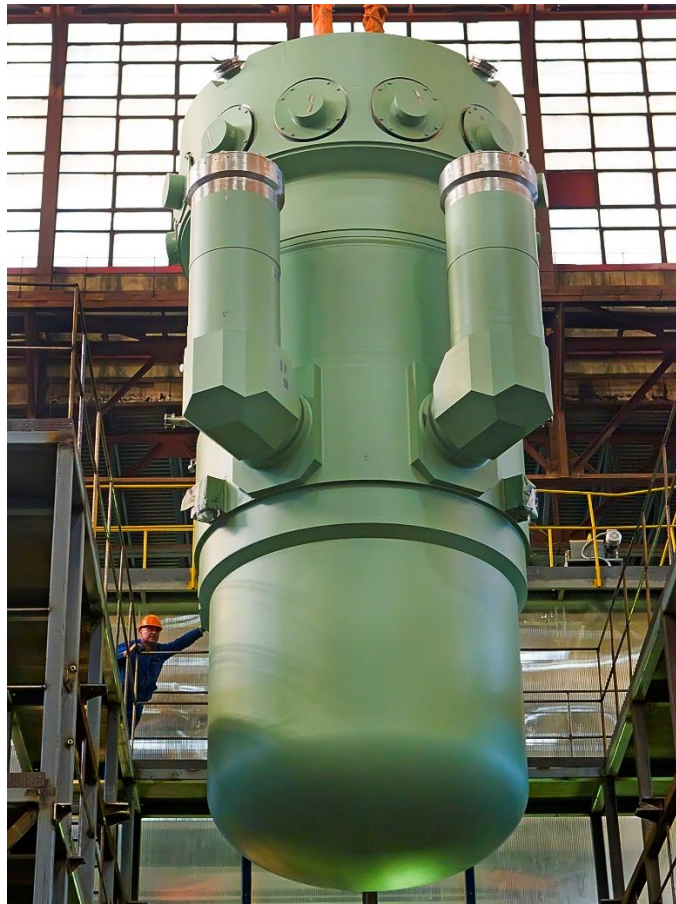
Рисунок 2. Корпус реактора ледокола проекта 22220 с энергетической установкой «РИТМ-200» на производственной площадке акционерного общества «Машиностроительный завод «ЗиО-Подольск» (подготовка к отгрузке)
